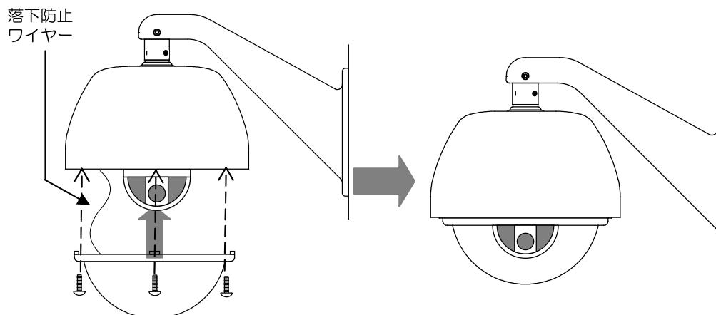
※落下防止ワイヤーを外した状態で設置作業を行った場合、ドームカバーを取り付ける際には必ず落下防止ワイヤーを取り付けるようにしてください。
