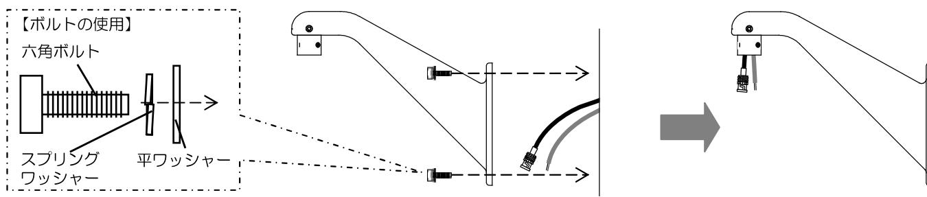
※壁付けブラケットと壁面が接する部分についてはコーティングを施して下さい。雨水や虫、ホコリ等が侵入する原因となります。
