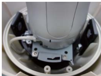
9. ケーブルをカメラ本体に接続し、プレートに取り付けます。 ※参考画像：Panasonic製PTZカメラ SC385
