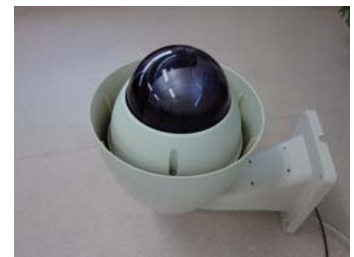
10. 本体にドームカバーを取り付け、ビスを3点締め付けて完成です。
