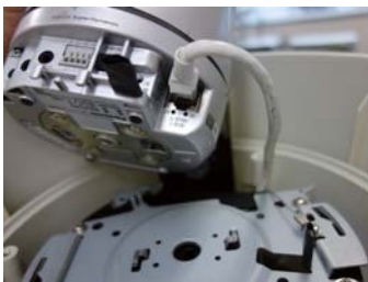
9. ケーブルをカメラ本体に接続し、プレートに取り付けます。 ※参考画像：Panasonic製PTZカメラ SC385
