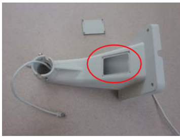
3. ブラケットに人線し、本体接続部より出します。 必要に応じて、赤丸の通線口を付属の六角レンチで開けて作業してください。
