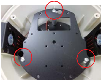
1. 本体カバーを開けて内部の3つのビスを緩め、プレートを取り外します。
