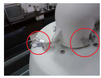
5. 締め付け後、ブラケットについている落下防止ワイヤーで本体とブラケットをつなぎます。
