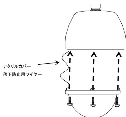
1) アクリルカバーをハウジング本体に取付ける時、付属の六角調整ネジで4箇所を確実に固定して下さい。
