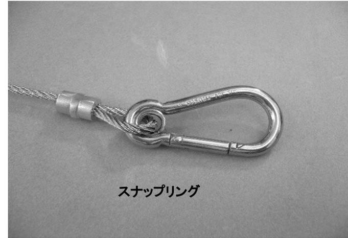
3) 落下防止ワイヤーに付いているスナップリングをアンカーに取付けて下さい。
