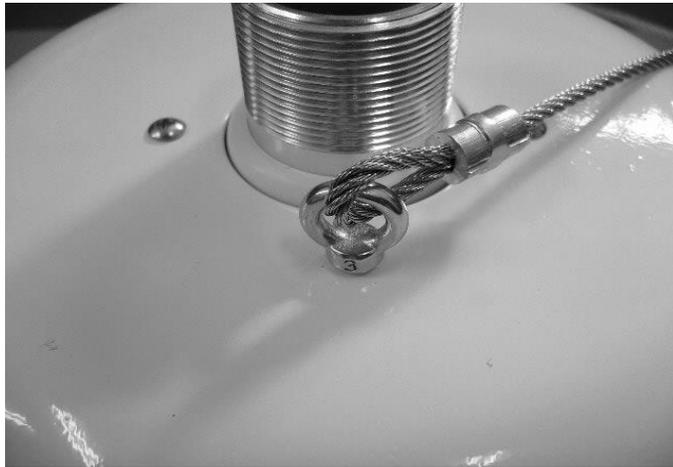
2) サンシールド取付ネジ(M3×6)を取外したところに、落下防止ワイヤーの先に付いているアイボルト(M3)を取付けます。
