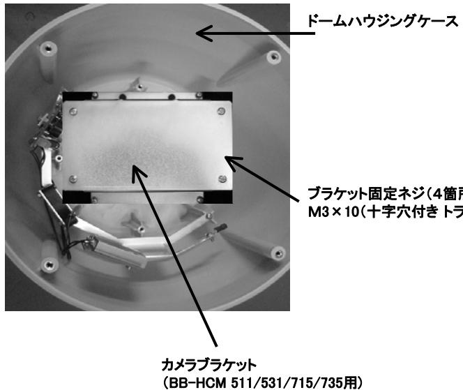
1) ケース内部のブラケット固定ネジ(4箇所)を緩め、カメラブラケット(BB-HCM 511/531/715/735用)を取外してください。
