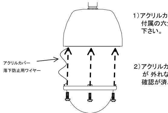
1) アクリルカバーをハウジング本体に取付ける時、付属の六角調整ネジで4箇所を確実に固定して下さい。
