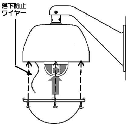
ドームカバーの六角ネジ4箇所をすべてハウジングのネジに合わせ、六角ネジを締めて確実にこていします。
