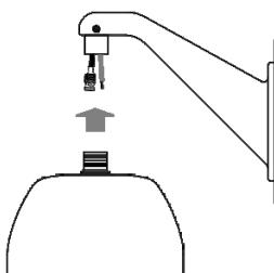
注)連接ブラケットがケースとブラケットに、確り取付けてある事を確認して下さい。
